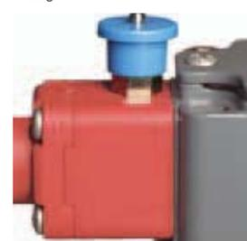
Wenn sich der Spannungsanzeiger des Seils in der Zone der korrekten Anziehung befindet, können die elektrischen Sicherheitskontakte durch das Ziehen am blauen Knopf geschlossen werden. Der grüne Signalisierungsring gibt eine sofortige Auskunft über den Schalterzustand.
