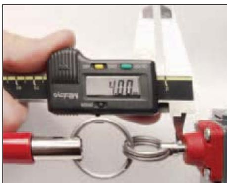
**Für Schalter mit Kopf 74:** das am Schalter befestigte Seil so spannen, bis sich die Ringschraube ungefähr 4 mm vom Kopf entfernt befindet.
