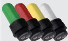
Diese Anzeigeleuchten werden dazu verwendet, um eine Zustandsveränderung eines elektrischen Kontaktes innerhalb des Schalters anzuzeigen. Diese können an den Schaltern angebracht werden, indem man sie an einen freien Kabeleingang schraubt. Schutzart IP67.
