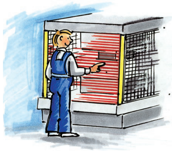
Sensordetektionsvermögen zur Fingererkennung
