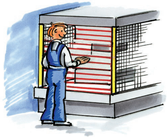
Sensordetektionsvermögen zur Handerkennung
